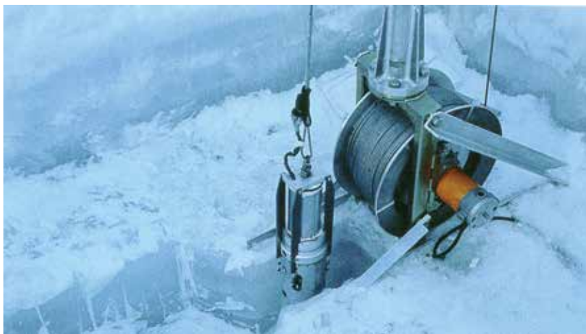
南極観測「氷床深層掘削装置用電動ウインチ MAW-1100 型」
